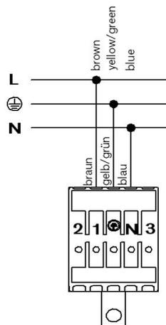
Je nachdem ob 3-Pol, Abb. links oder 5-Pol Kabel, Abb. rechts, verwendet wurden.
