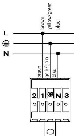
Je nachdem ob 3-Pol, Abb. links oder 5-Pol Kabel, Abb. rechts, verwendet wurden.
